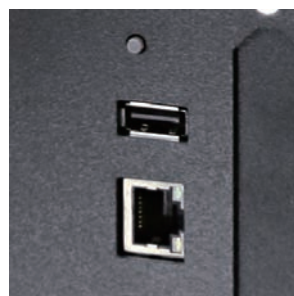
Interface USB Host que permite el funcionamiento autónomo, sin necesidad de PC
